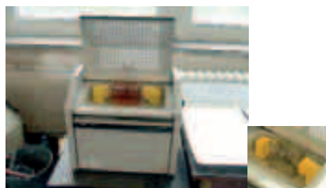
Zkoušení průrazného napětí transformátorového oleje.
