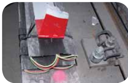
↑ Programový pás vlakového zabezpečovače Matra PA-135. ↗ Skříně elektronického zabezpečovacího zařízení v reléové místnosti stanice Ládví.
