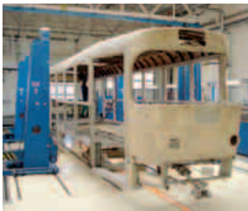
Hrubá stavba vozu T3 po otryskání.
