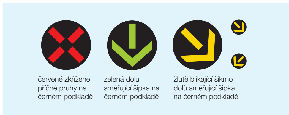
Dynamická signalizace pro jízdní pruhy – tzv. „stálé světelné znaky“ – používaná v Německu.
