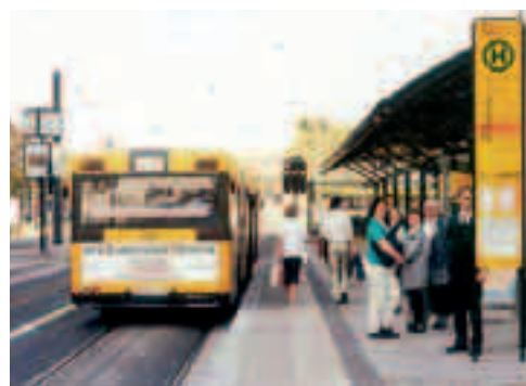
Společné jízdní pruhy pro tramvaje a autobusy nabízejí kromě dalších výhod i zřízení společné, tj. pro cestující přehledné zastávky (Dražďany).
