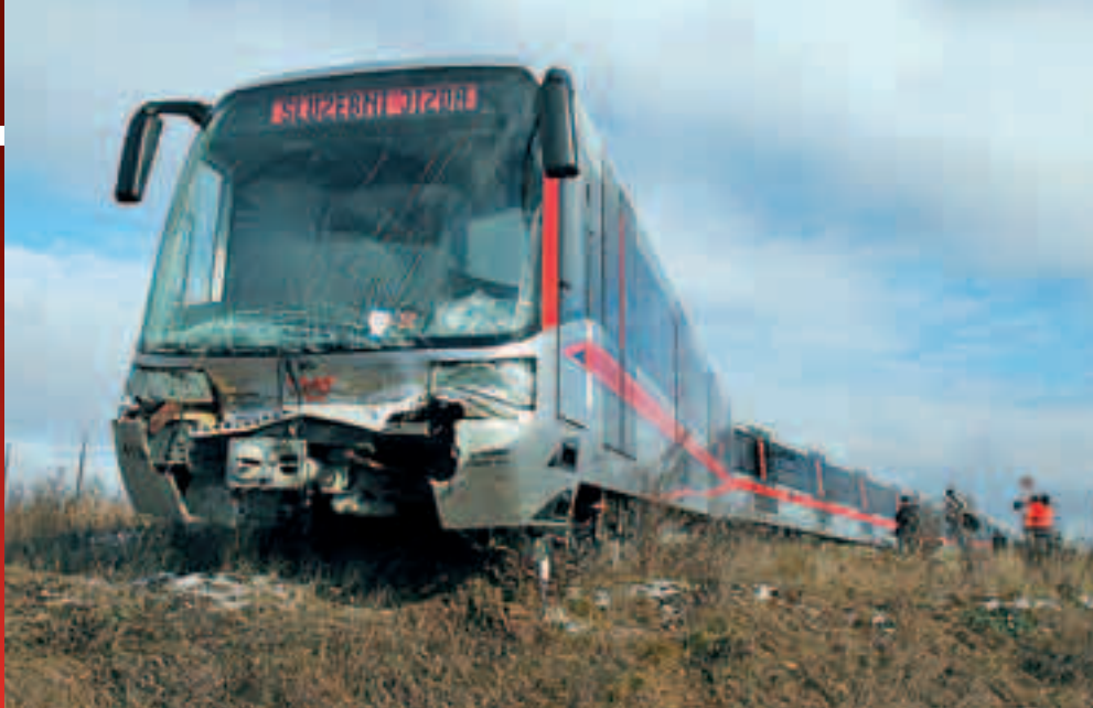
Vykolejená souprava na zkušební trati v depu Zličín. Foto © Bezpečnostní úsek
