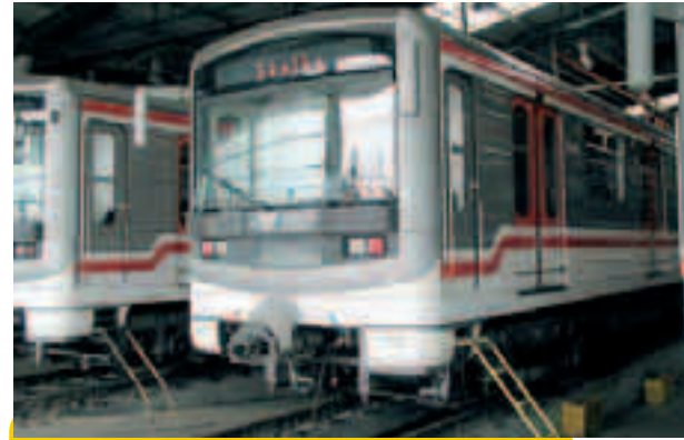
V depu Hostivař je připravena vlaková souprava, typu 81-71M se zabezpečovačem ARS na večerní zkušební jízdu do oběhu 55 na lince A. Po ukončení zkoušek budou tyto soupravy nasazovány na linku B.
