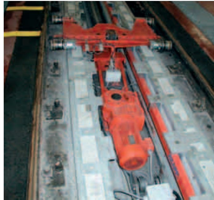
Detailní pohled na posunovací zařízení. Vůz metra najede do vymezeného prostoru. Zařízení „uchopí“ kola na jedné nápravě a odbrzděnou soupravu pomocí elektromotoru a pevně zabudovaného undávacího hřebenu posune stacionární myčkou.
