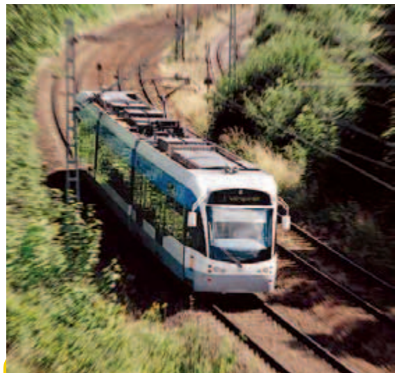
Dvousystémová článková Tram-Trein vozidla od firmy Bombardier se mohou „prohánět“ rychlostí 100 km/h.
