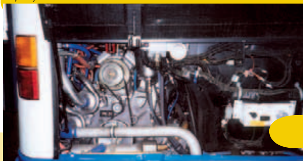
Motorový prostor autobusu, kde elektromotor nahrazuje naftový motor.
