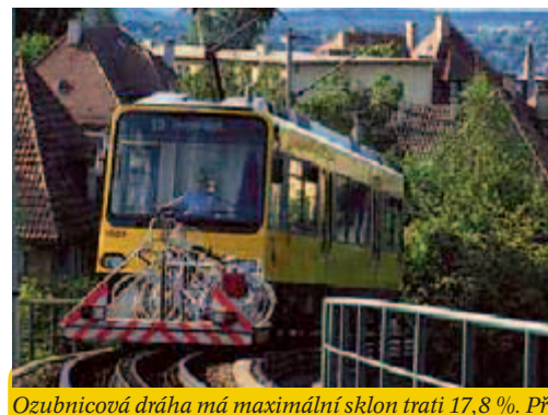
Ozubnicová dráha má maximální sklon trati 17,8 %. Při pěkném počasí nastává boj o místa pro kola umístěvaná na speciálním vozíku.
