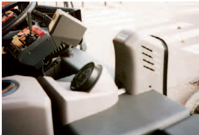
Pod šedým krytem v pravé části obrázku je ukryta kamera optického navádění.
