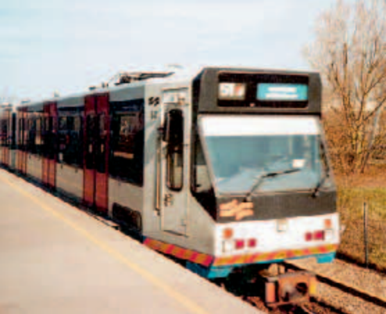
Sneltram ve stanici RAI, tedy v úseku, kde je napájena ze třetí kolejnice.
