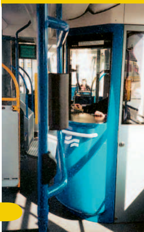
Stanoviště průvodčího v tramvaji typu Combino.
