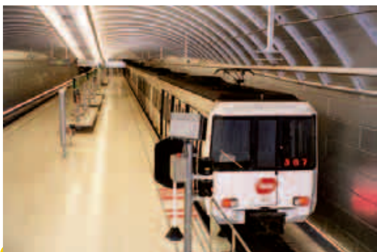
Moderní souprava metra řady 3000 ve stanici Canyelles na lince L3. V pětičlenné soupravě jsou vždy řazeny 4 motorové a jeden vlečný vůz.
