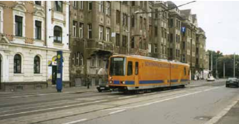
Šestinápravový článkový kolejový brus ve čtvrti Angerbrücke.
