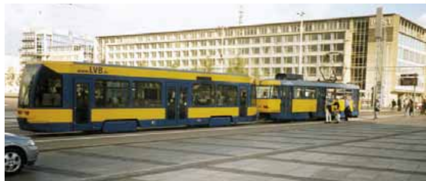
Nízkopodlažní vlečný vůz typu NB4 č. 910 (Bombardier) z roku 2000 v soupravě s o dvacet let starším českým vozem Tatra T4D.
