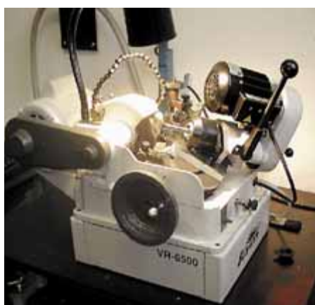
Speciální přístroj pro zabrušování ventilů
