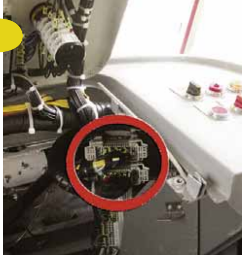
Umístění konektorů ILME v panelu řidiče.
