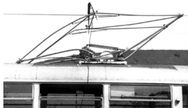
Zkoušky pantografu na 5091 v květnu 1957. Vůz měl sběrač tyčový se smykadlem nad zadním podvozkem a pantograf (zde po stržení na Kotlářce) nad předním podvozkem.
