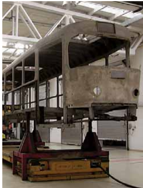
Skříň vozu po odstrojení.
