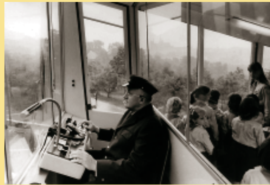
Na první pohled by se zdálo, že se díváte na řidiče, ale nenechme se mýlit. Je to sice obsluha lanovky, ale provoz je plně automatický, řízený počítačem z horní stanice.
